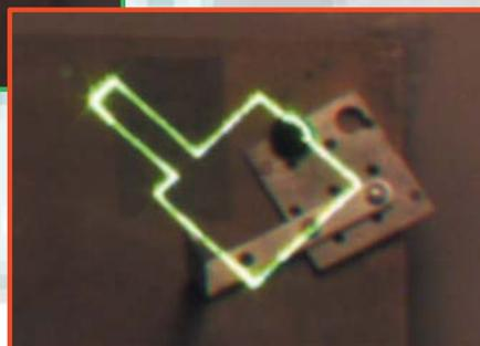
**AIDE À L'ASSEMBLAGE PAR PROJECTION LASER**
