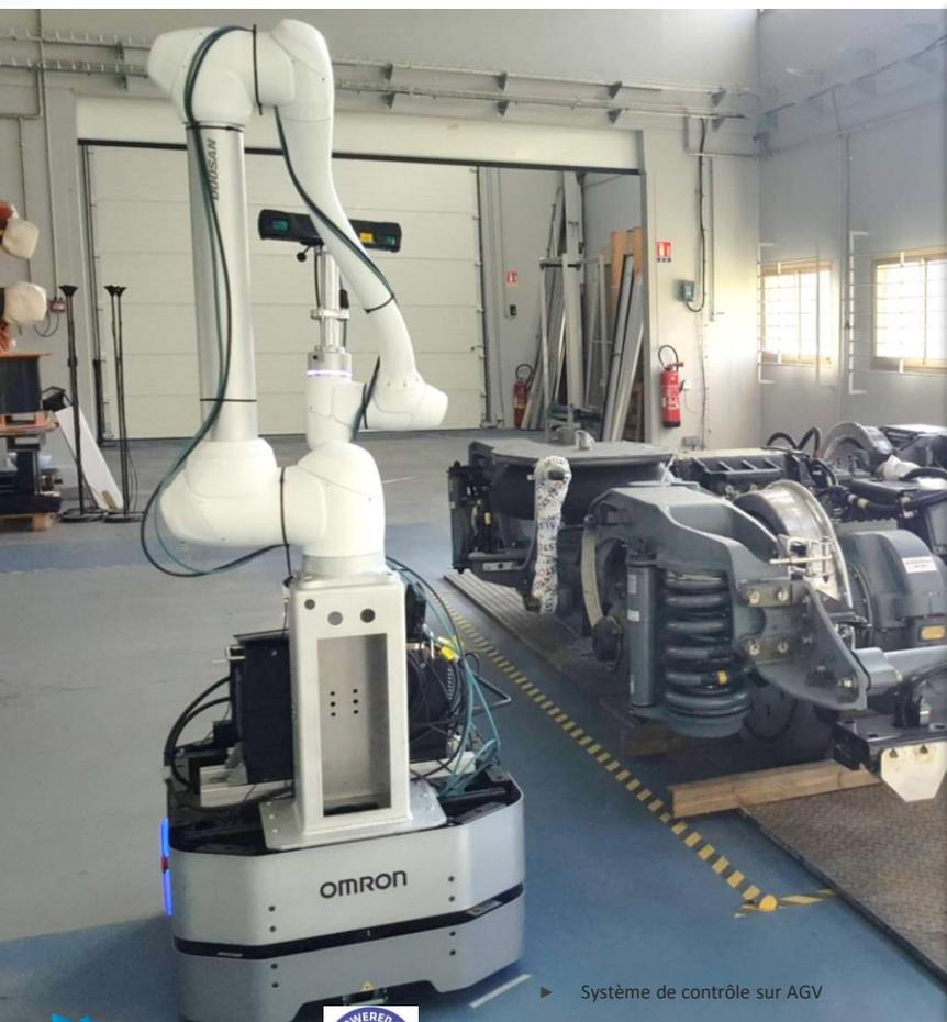
► Système de contrôle sur AGV
